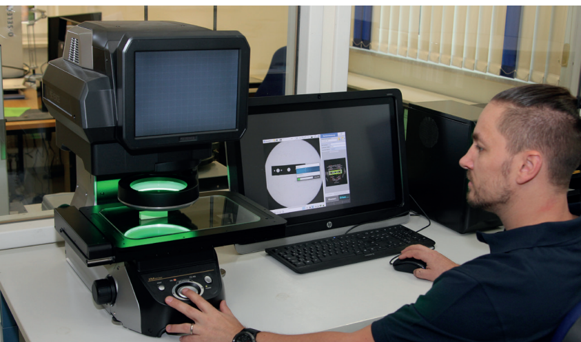
Bild 3 Selbstkalibrierende optisch/taktile Messmaschine Keyence IM
